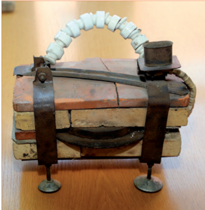
Selbstgebauter elektrischer Ofen aus Schamottesteinen und Dachziegeln Foto: Niels P. Jørgensen
